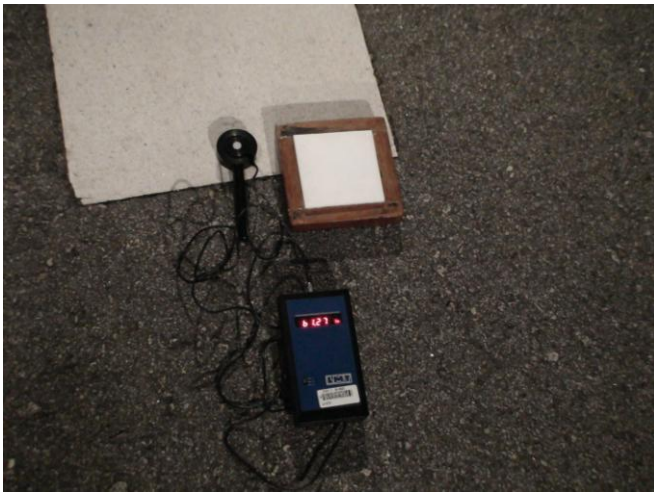
Fig. A.5- Posição do sensor de luz e referência da cor branca (placa PTFE 10x10cm) junto a faixa para pedestres, quando a iluminância foi amostrada na CUASO/USP, equipamento iluminante tipo SSL (WLEDi), Av. Prof. Luciano Gualberto. Fonte: foto própria, em Abr./2015.
